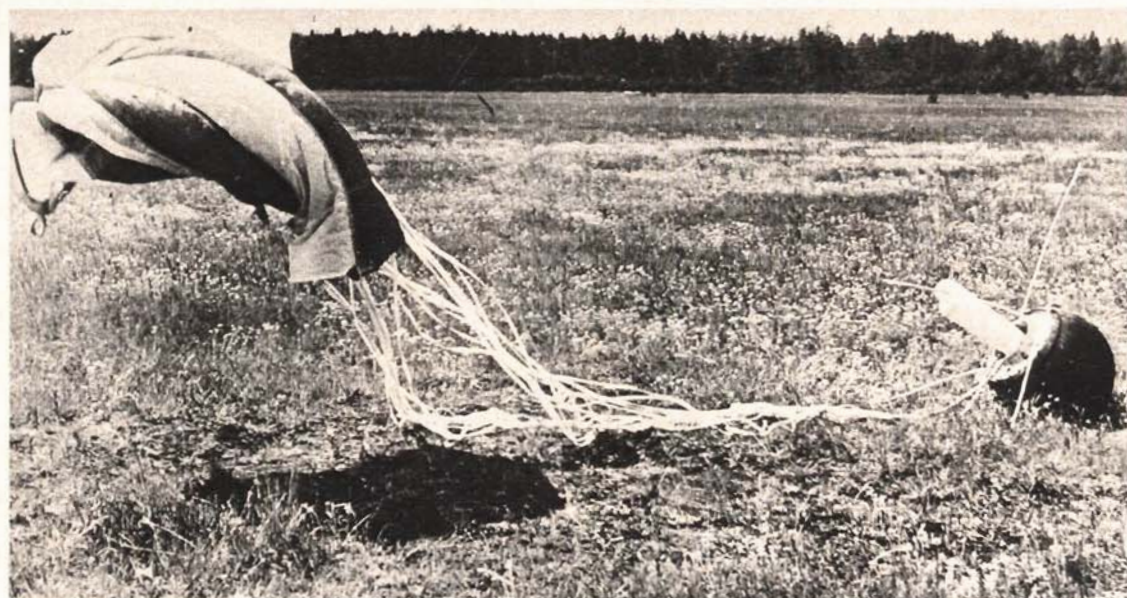
Un modello a scala naturale della capsula « Luna 16 » durante una prova d'atterraggio « morbido ».
