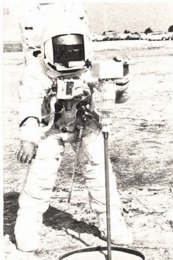
In alto, Lovell e Haise si esercitano nella manovra delle canne da inserire nel trapano che effettuerà sondaggi del suolo lunare fino a tre metri di profondità. A destra, Haise mostra il funzionamento del motore del trapano, che affonda nel terreno come una vite.
