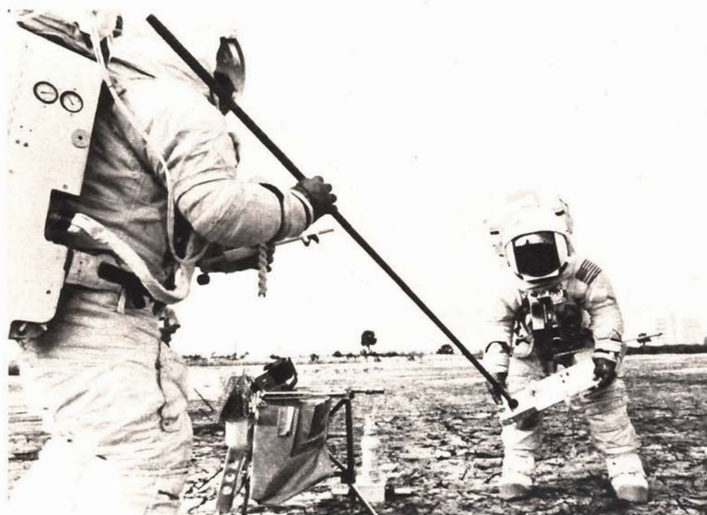
In alto, Lovell e Haise si esercitano nella manovra delle canne da inserire nel trapano che effettuerà sondaggi del suolo lunare fino a tre metri di profondità. A destra, Haise mostra il funzionamento del motore del trapano, che affonda nel terreno come una vite.
