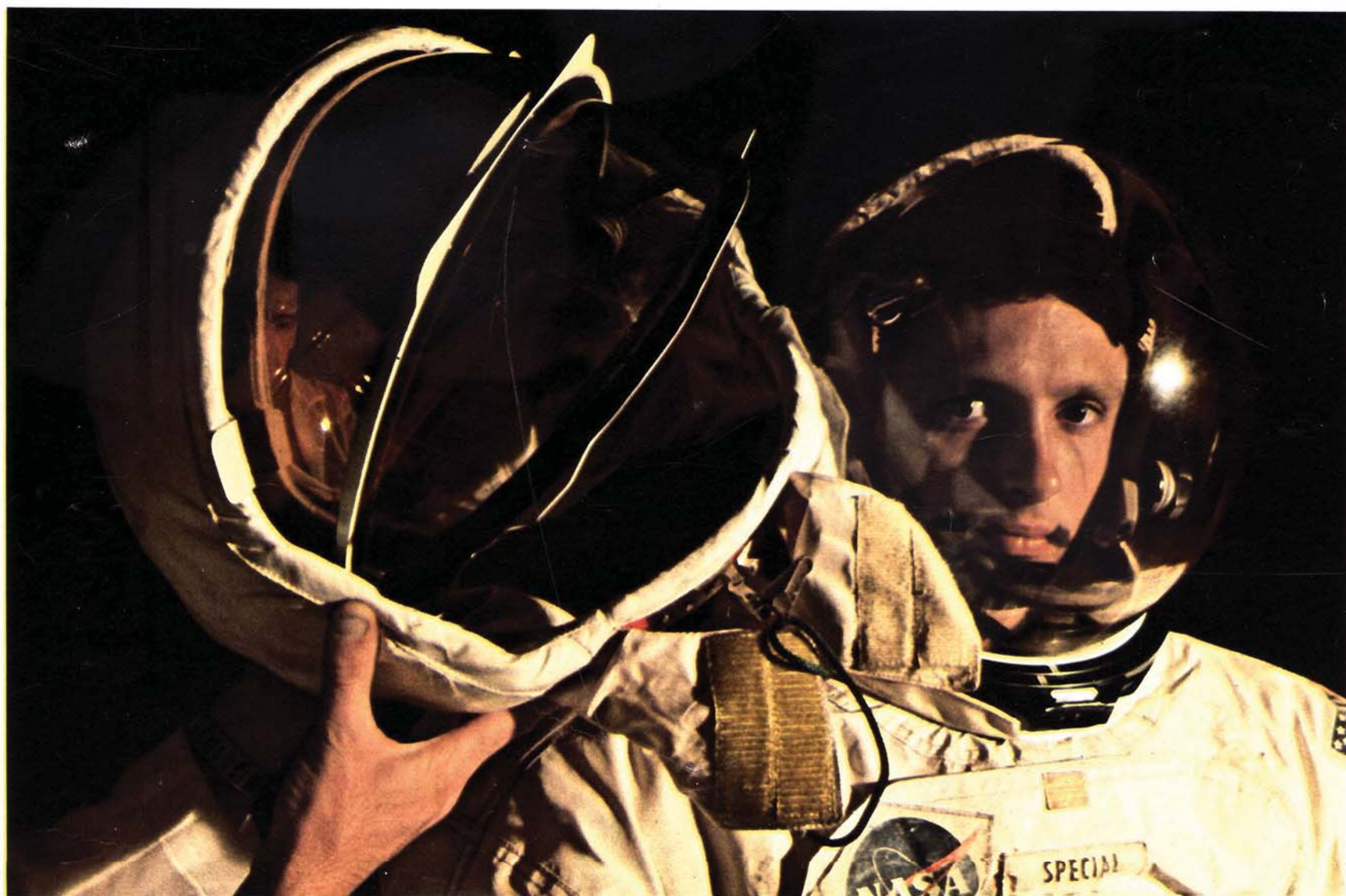
Il casco lunare è una delle parti più importanti della tuta; la scelta delle sostanze plastiche che lo costituiscono ha richiesto parecchi anni di ricerche.
