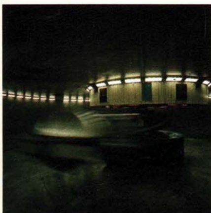
La centrifuga, con la « gondola » per gli astronauti. L'apparecchio, girando vorticosamente, simula le condizioni di gravità in cui i piloti si trovano al lancio e al rientro dallo spazio.
