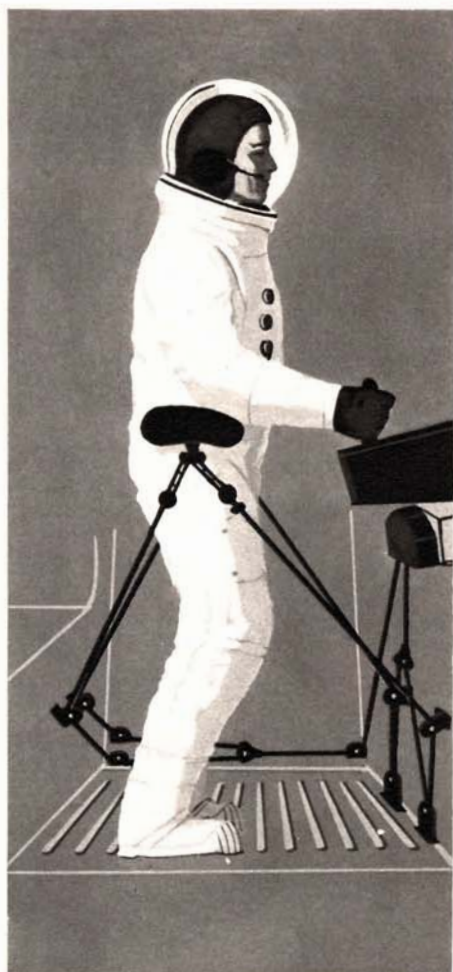
Il disegno rappresenta in schema il dispositivo che tiene gli astronauti bene « ancorati » al pavimento del LEM, affinché essi non risentano delle variazioni d'assetto della navicella. La « scatola » indicata con la freccia contiene un meccanismo che regola automaticamente la tensione del sistema di cavi fissato alla tuta.
