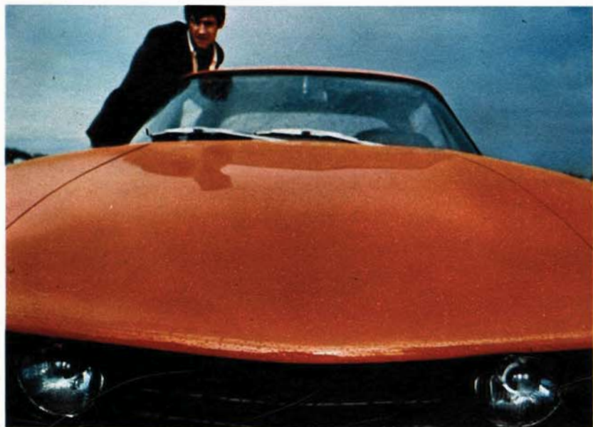
L'auto «tuttaplastica» della Bayer. Salvo il motore, il cambio e le altre parti meccaniche, il veloce coupé-sport è realizzato con materiali sintetici.
