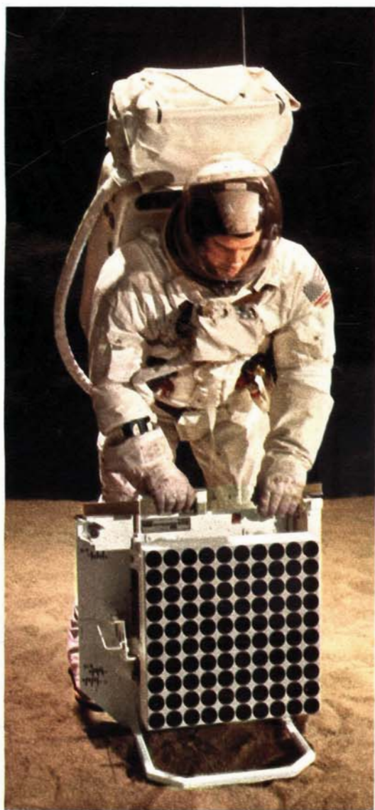
Lo «specchio» laser che Armstrong e Aldrin lasceranno sulla Luna. Questo apparecchio, che dovrà essere accuratamente orientato, rifletterà, secondo angoli noti, un raggio di luce laser proveniente dalla Terra. Lo scopo dell'esperimento è di conoscere con estrema precisione la distanza Terra-Luna, le distanze tra vari punti del nostro globo (non sempre note con esattezza) e la posizione reciproca dei due corpi celesti in ogni fase delle loro orbite.
