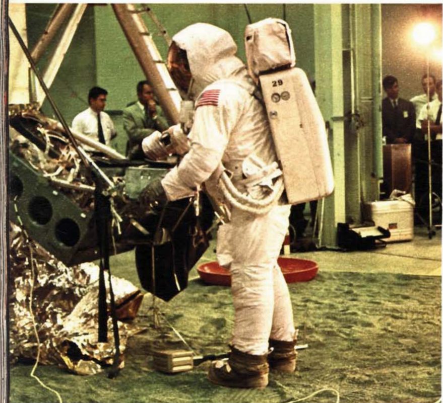
Nella sequenza qui sopra, Armstrong e Aldrin si esercitano a scaricare dal «portabagagli» del LEM le attrezzature che useranno sulla Luna. Tutta l'operazione si svolge tirando delle cinghie, che provvedono a far ribaltare il portello e ad estrarre i vari strumenti dal contenitore situato nella base del Modulo lunare.
