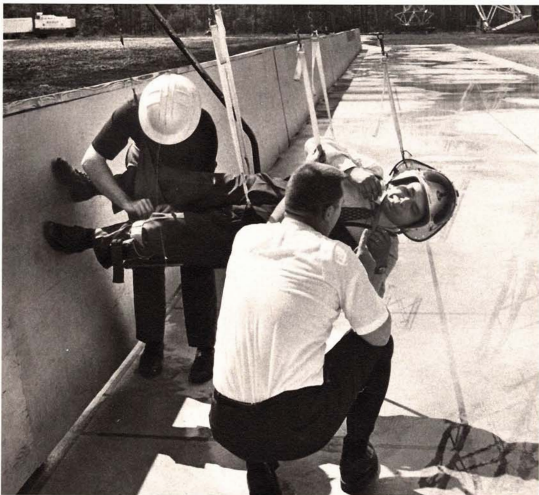
Il nostro inviato si appresta a sperimentare di persona l'apparecchio che simula la gravità ridotta lunare: due tecnici della NASA lo stanno aiutando ad entrare nell'imbracatura di cinghie e cavi collegati alla « macchina ». Questa provvede, con un sistema di molle e pompe idrauliche, a « sottrarre » gran parte del peso.
