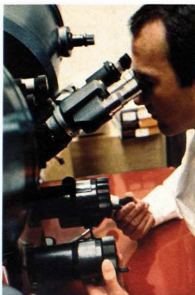
Con la microsonda si possono scoprire ed analizzare irregolarità di ordine microscopico nel materiale.
