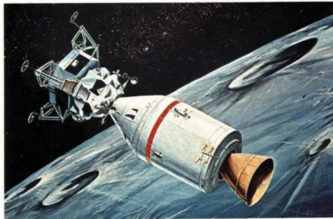
In alto: il complesso di astronavi costituito dal Modulo di servizio, dalla capsula Apollo e dal LEM raggiunge la Luna dopo quasi tre giorni di viaggio e si stabilizza in un'orbita distante dal nostro satellite circa 112 chilometri. Gli astronauti Stafford e Cernan si trasferiscono nel LEM per cominciare la loro navigazione autonoma. In basso, ecco come appare la superficie lunare dalla quota di « parcheggio », situata lungo un'orbita quasi esattamente circolare.
