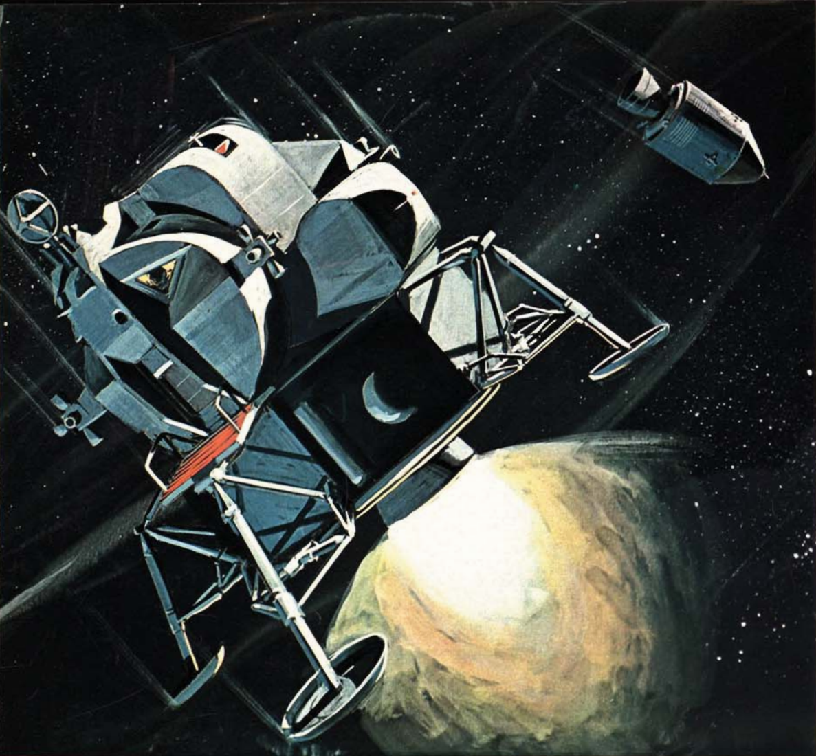
Il LEM si distacca dalla capsula Apollo e accende il motore principale per cambiare orbita.
