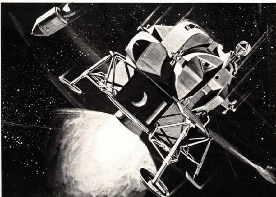
7 Il Modulo lunare è dotato di un motore principale che verrà usato per frenare e orientare la discesa sul suolo della Luna. Adesso, questo propulsore viene acceso in modo da imprimere al Modulo una spinta che lo porterà ad allontanarsi sempre più dalla capsula-madre Apollo.
