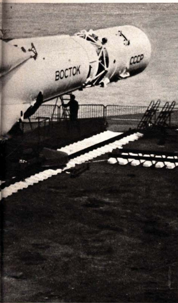
A sinistra, una copia in scala dell'astronave sovietica Vostok, che mise in orbita i primi cosmonauti. Particolarmente complesso era il primo stadio composto da cinque missili riuniti a cono, ciascuno dei quali dotato di quattro motori principali. Questa immagine fu resa nota più di cinque anni dopo l'impresa di Gagarin, quando la Vostok era stata già superata dalla più grande e più potente astronave Voskod, capace di trasportare una capsula « triposto ».
