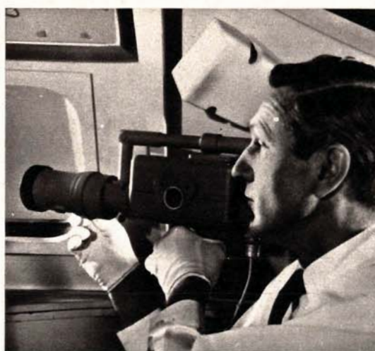
In alto, la telecamera che ha trasmesso le immagini viste in tutto il mondo. Si tratta di un apparecchio il cui schema è uguale a quello delle telecamere usate negli «studi», ma estremamente miniaturizzato: pesa, infatti, un chilo e 830 grammi. Ha due obiettivi: un «grandangolare», usato per le riprese interne, e un «tele», per le riprese lontane. In basso, il pranzo di Natale degli astronauti, confezionato nei soliti contenitori in plastica, ad eccezione del tacchino, che era in un involucri di alluminio, per conservarne meglio il sapore.
