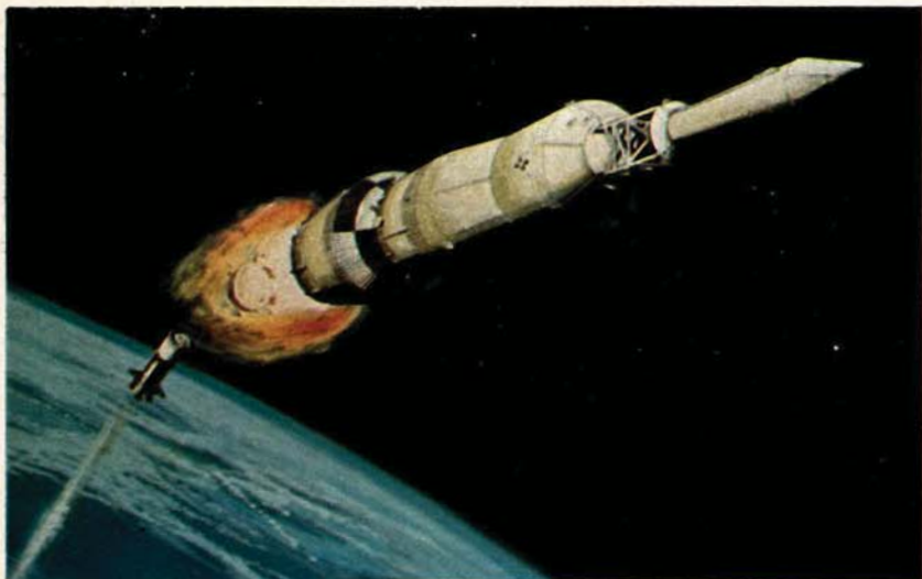
1 Due minuti e mezzo dopo il lancio dal « Porto della Luna » presso Cape Kennedy, il primo stadio del Saturno è ormai esaurito ed il secondo stadio si accende per aumentare la velocità.
