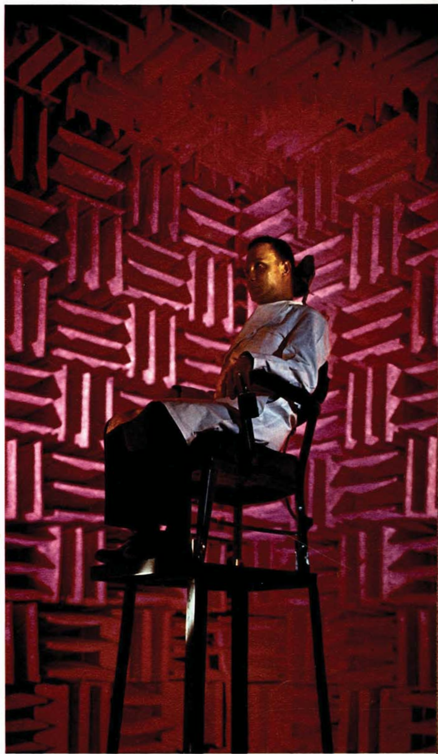
In alto: uno scienziato compie esperimenti in una « camera senza echi ». I suoni sono assorbiti dai pannelli di plastica disposti tutt'intorno, tanto che diventa difficile stabilirne la direzione di provenienza. In questo ambiente si può simulare quasi perfettamente il silenzio cosmico. ↑
