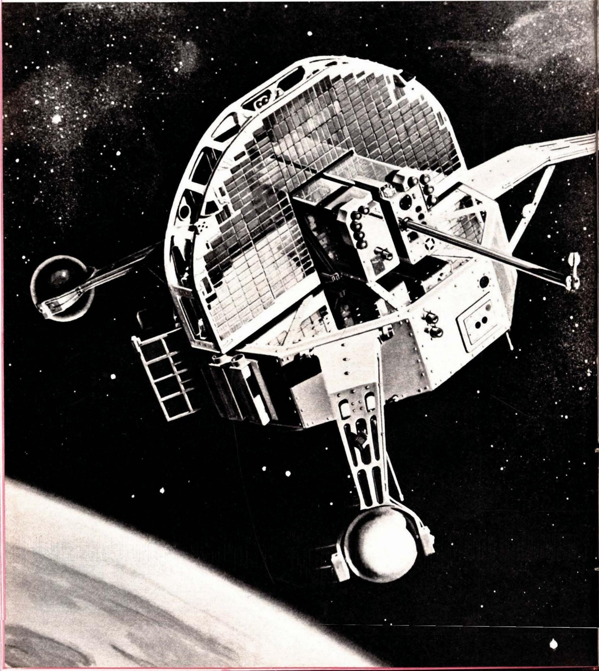
Questo satellite artificiale, dalla forma di poligono a nove facce, è un osservatorio scientifico che sarà lanciato lungo un'orbita solare dagli scienziati americani. Contiene numerose apparecchiature per la rilevazione dei fenomeni radioattivi della nostra Stella. Si chiama OSO, vale a dire Orbiting Solar Observatory.
