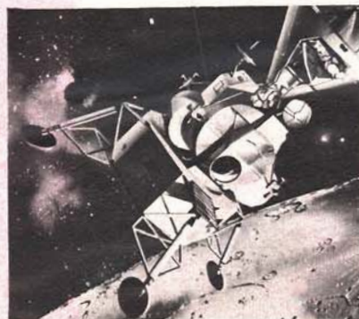
Un disegno della « cimice » a bordo della quale due astronauti sbarcheranno sulla Luna, mentre il loro compagno li attenderà sul « veicolo-madre ». La « cimice » si poserà sul suolo lunare frenando con i razzi ed assorbendo l'urto finale con i quattro « piedi » telescopici. Parte dell'apparato sarà abbandonato sulla Luna.
