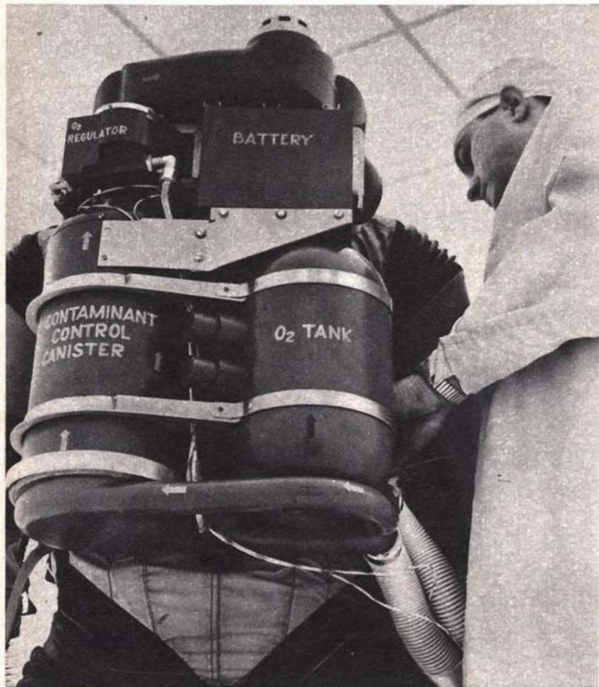
L'astronauta che scenderà sulla superficie lunare porterà sul dorso un serbatoio d'ossigeno che gli consentirà 4 ore di autonomia. Una volta esaurita, la bombola potrà essere ricaricata a bordo della capsula.
