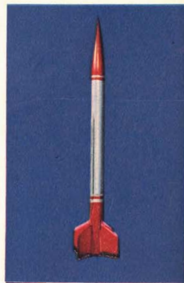
1923. Viene progettato da Oberth questo razzo pre-cosmico a due stadi, con impiego di propellenti liquidi.
