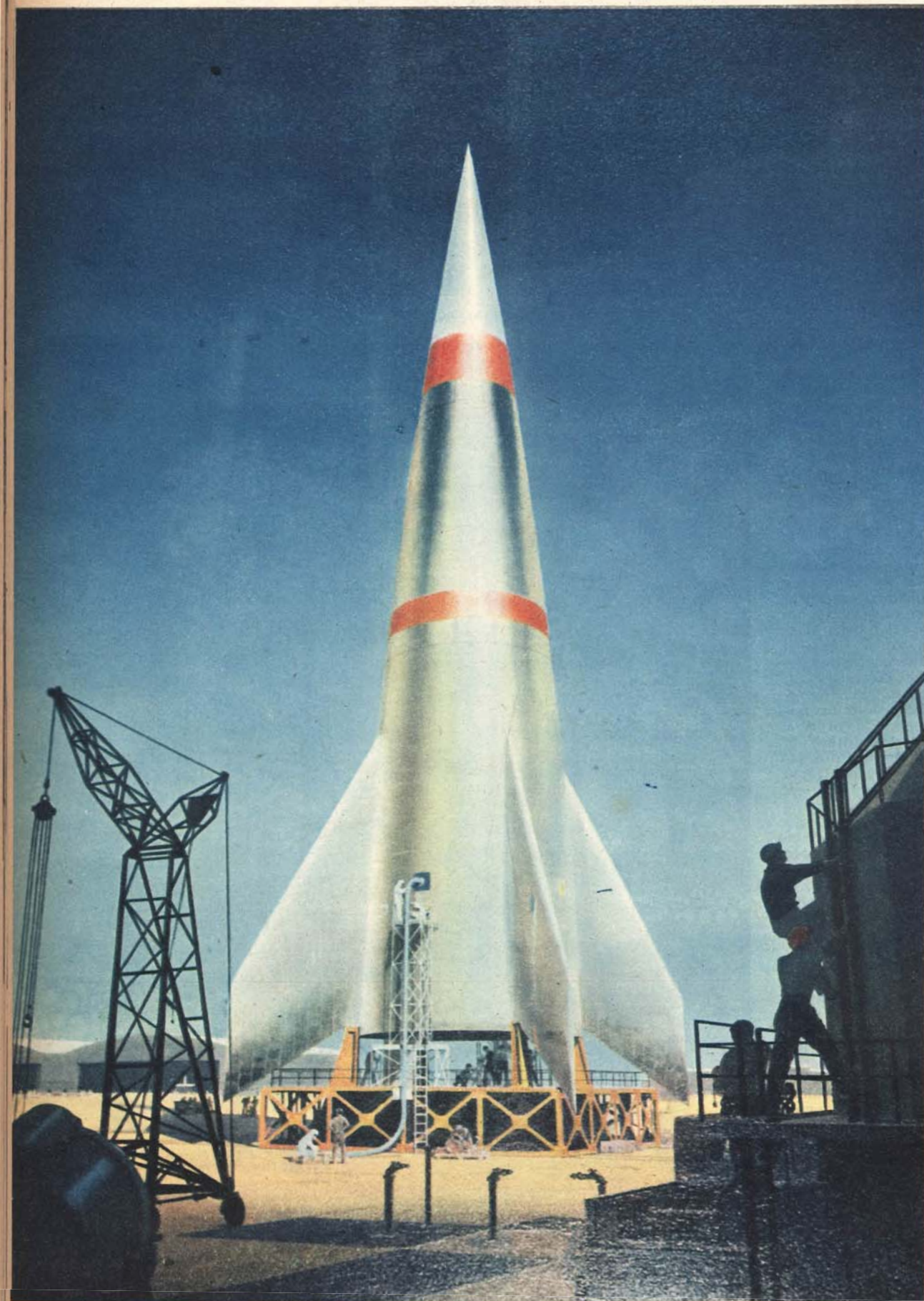
La piccola stazione spaziale pronta per il lancio. Delle tre sezioni, le prime due, partendo dal basso, serviranno per la propulsione e si staccheranno una alla volta dal tronco di cono superiore contenente gli apparecchi di misurazione.
