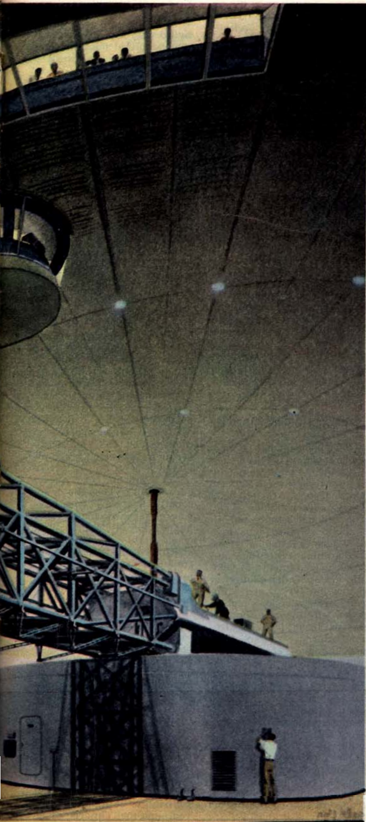
Questa gigantesca macchina addestra contemporaneamente cinque persone alle enormi pressioni dovute all'accelerazione di gravità. La cabina, montata su un gigantesco braccio, ruota a velocità vertiginosa: all'interno, l'equipaggio viene spinto con violenza contro i sedili dalla forza centrifuga. Sopra: L'interno della cabina d'una macchina centrifuga. L'equipaggio è sottoposto al terribile sforzo di un'accelerazione che corrisponde a 9 volte il peso del corpo umano.
