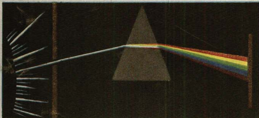
Newton scoprì che il prisma (e un po' anche una lente) scinde il raggio luminoso e scompone la luce bianca in una serie di raggi variamente colorati. Perciò studiò un telescopio di nuovo tipo, nel quale il raggio di luce proveniente dall'oggetto non attraversa la lente dell'obiettivo ma viene riflesso da uno specchio concavo e proiettato nell'oculare. In tal modo eliminò il difetto dell'immagine iridata che caratterizzava i telescopi di vecchio tipo, rendendo possibile una osservazione della volta celeste più adeguata alle esigenze degli astronomi.
