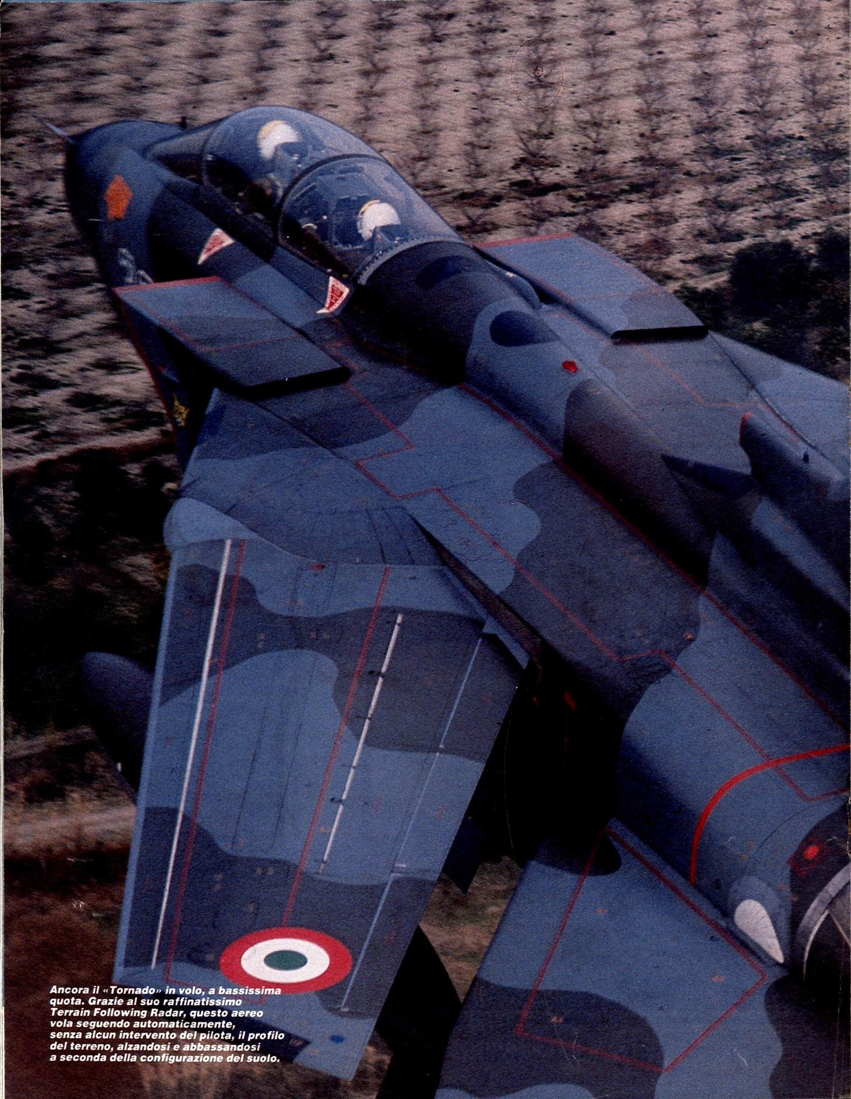
**Ancora il «Tornado» in volo, a bassissima quota. Grazie al suo raffinatissimo Terrain Following Radar, questo aereo vola seguendo automaticamente, senza alcun intervento del pilota, il profilo del terreno, alzandosi e abbassandosi a seconda della configurazione del suolo.**
