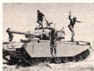
Carro armato *Centurion*, di produzione britannica. Peso 52 tonn.; spessore delle corazze da 80 a 152 mm.; armamento, un cannone da 105 mm. e due mitragliatrici da 12,7 mm.; autonomia 185 km.; equipaggio 4 uomini.
