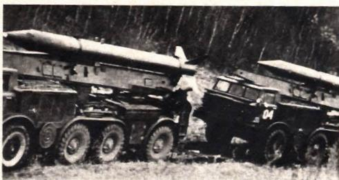
Lanciamissili *Frog-7*, di fabbricazione sovietica. Caratteristiche del missile: lunghezza 10,5 metri; calibro 40 centimetri; peso 2100 chilogrammi; esplosivo 500 chilogrammi; gittata 70 chilometri; autonomia dell'automezzo 150 chilometri.
