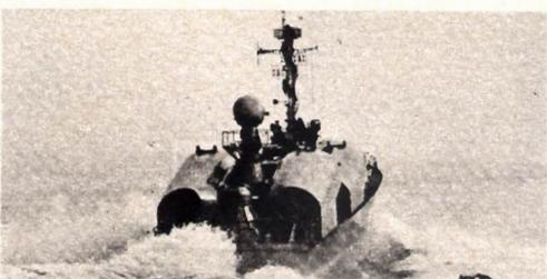
Motovedetta lanciamissili della classe *OSA*, di costruzione sovietica. Dislocamento 200 tonnellate; velocità 35 nodi; armamento, 4 lanciamissili, quattro cannoni da 30 millimetri. Questo battello è attualmente fra i migliori del suo tipo.
