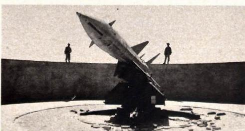
Missile terra-aria radiocomandato *SA 2*, di fabbricazione sovietica. Lunghezza 10,6 metri; diametro 51 centimetri; peso 2270 chilogrammi; esplosivo 131 chilogrammi; gittata 40 chilometri; altezza massima raggiungibile 18.300 metri.
