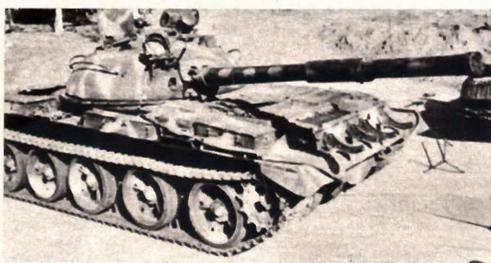
Carro armato *T. 62*, di fabbricazione sovietica. Peso 40 tonn.; spessore della corazza alla torretta 115 mm.; armamento, un cannone da 115 millimetri e una mitragliatrice cal. 7,62; puntamento con raggi infrarossi. Equipaggio 4 uomini.
