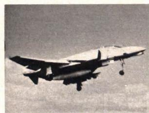
Caccia - bombardiere *Phantom F-4*, di fabbricazione americana. Velocità 2400 km. orari; autonomia 3700 km.; armamento, un cannoncino da 20 mm., missili o razzi o bombe per 720 kg.; equipaggio due uomini.
