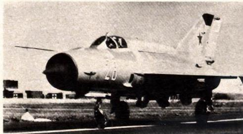
Caccia *MIG 21 MF*, di fabbricazione sovietica. Velocità 2400 chilometri orari; autonomia circa 3000 chilometri; armamento, due cannoncini da 23 millimetri, due missili aria-aria o 32 razzi da 55 millimetri; un uomo d'equipaggio. Ulteriori dati sono nelle pagine precedenti.
