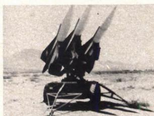
Missile terra-aria teleguidato *Hawk*, di fabbricazione americana. Lunghezza 5,3 m.; diametro 36 cm.; peso 587 kg.; velocità circa 3000 km. orari; gittata 35 chilometri; altezza massima raggiungibile 11.600 metri.
