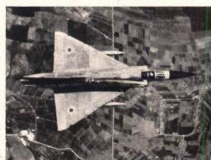
Caccia-bombardiere *Mirage III*, di costruzione francese. Velocità 2200 chilometri all'ora; autonomia 3000 km.; armamento, due cannoncini da 30 mm., missili o razzi o bombe per 454 kg.; equipaggio un solo uomo.
