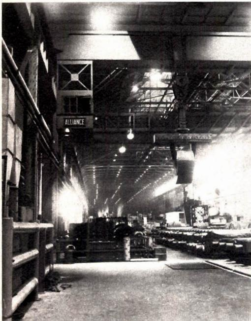
Impiegate le speciali Quartzline Rough-Service dove le lampade sono esposte ad urti e vibrazioni. Lampade Rough-Service montate su questa gru mobile illuminano il pavimento sottostante.
