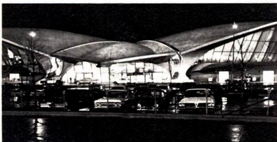
I profili architettonici di questa aereostazione sono messi in risalto da lampade Quartzline poco appariscenti, montate su pali a 15 metri dall'edificio. L'ampiezza del raggio luminoso può variare da 6° a 100°.
