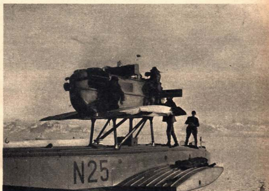
Si montano i motori dei «Dornier-Wal»: gli aerei mancano ancora delle ali che verranno applicate per ultime. In maggio il ghiaccio sostiene perfettamente.
