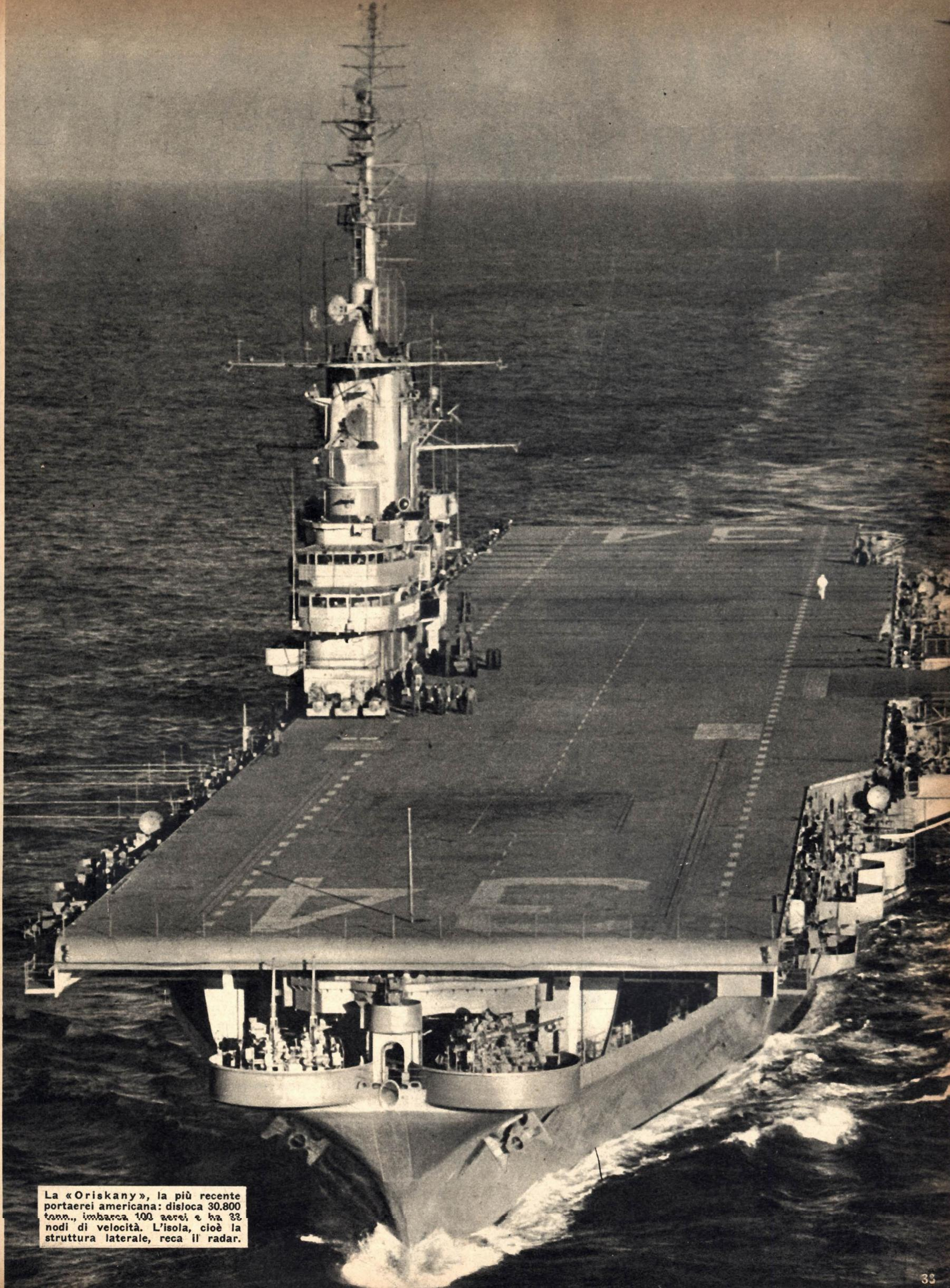
La «Oriskany», la più recente portaerei americana: disloca 30.800 tonne., imbarca 100 aerei e ha 32 nodi di velocità. L'isola, cioè la struttura laterale, reca il radar.
