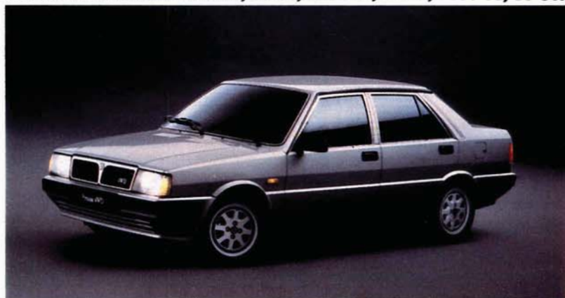
Lancia Prisma 4 WD: a trazione permanente integrale, 2000 cc, 120 Cv.
