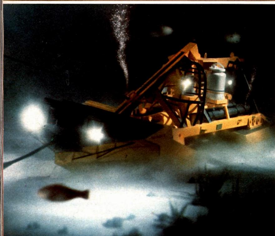
E con macchine come questo trattore-scavatore sottomarino che sono posati e vengono tenuti in ordine migliaia di chilometri di cavi telefonici in fondo al mare.
