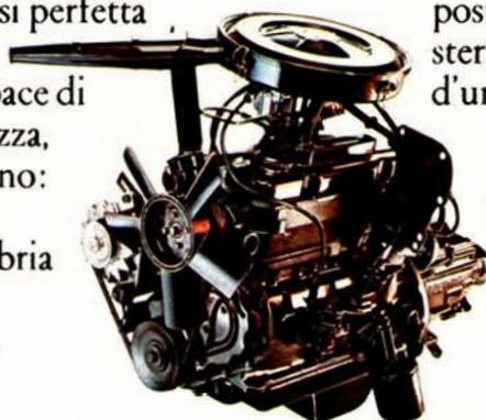
**Opel Manta. La tecnica:** Motore da 1196 cc, 60 cavalli DIN, velocità fino a 150 km/h, 5 posti, carrozzeria a struttura differenziata, sterzo di sicurezza ad assorbimento d'urto, sospensioni anteriori a ruote indipendenti, doppio circuito frenante con freni a disco anteriori e servofreno, dispositivo anti-inquinamento. La Manta è disponibile anche con motore 1600 cc, 1900 cc e in versione Rallye.
