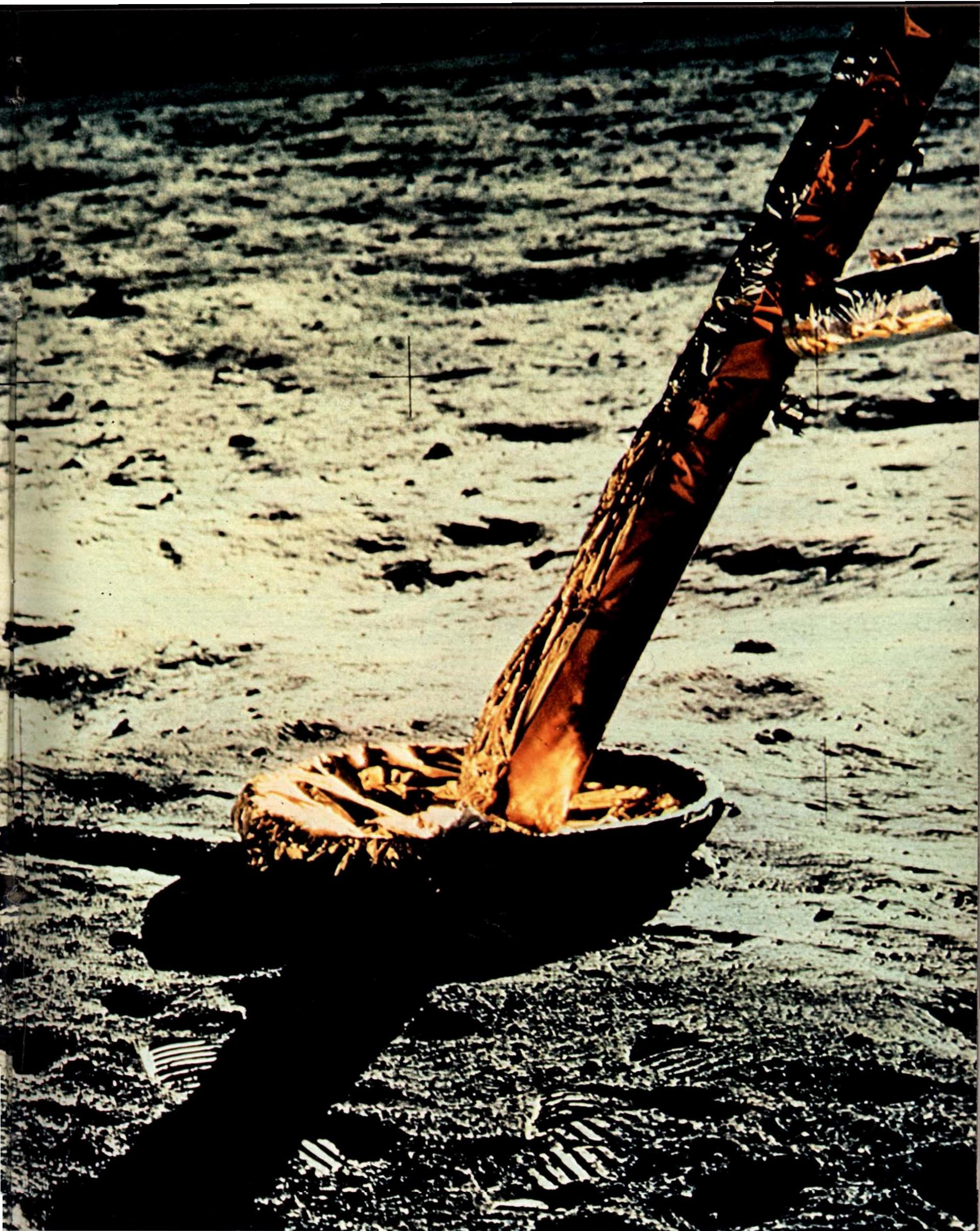
Gli strumenti di bordo della navicella hanno segnalato un'inclinazione di soli quattro gradi: si è nei limiti di sicurezza, ma bisogna rendersi conto di ogni dettaglio.
