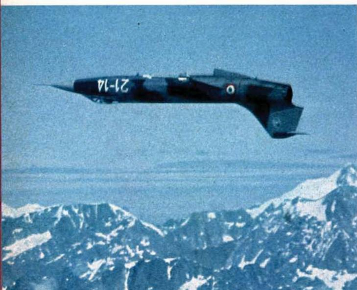
In volo rovesciato, sullo sfondo delle Alpi. Questo assetto non può mai essere mantenuto per lungo tempo dall'F 104, perché altrimenti si avrebbero difficoltà di alimentazione nel motore e inconvenienti di lubrificazione nel reattore.
