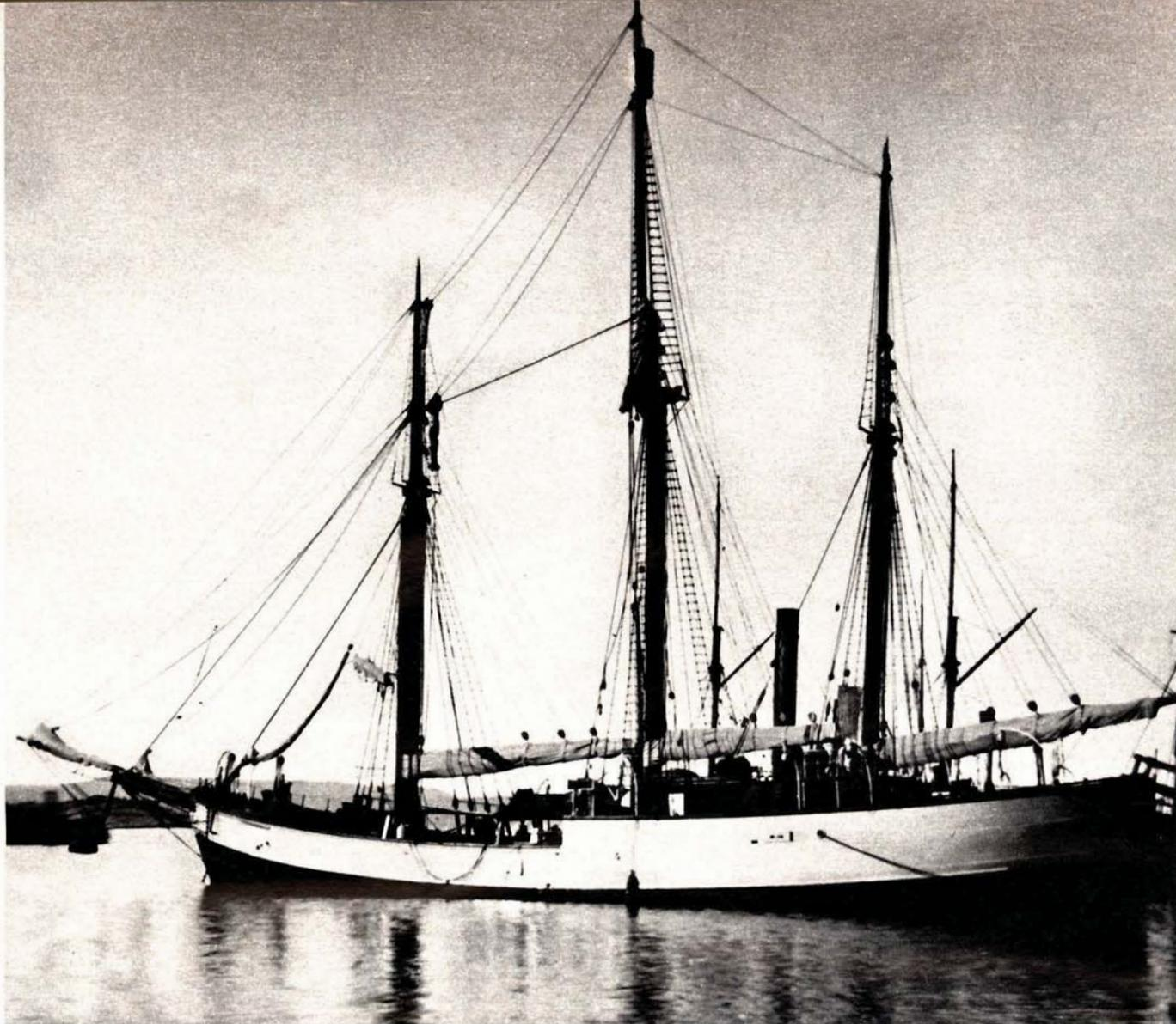
*Il Fram ancorato nel porto di Christiania: era una nave costruita appositamente per il viaggio polare, con uno scafo robustissimo e tondeggiante nella parte inferiore, per sfuggire alla morsa dei ghiacci. Alle spese per il suo armamento contribuirono molti cittadini e anche Oscar II di Svezia. Allora la Norvegia faceva parte del regno svedese: divenne indipendente nel 1905.*
