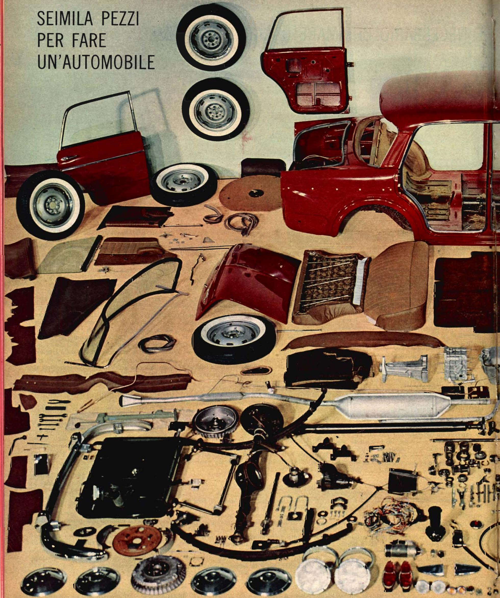
**ABBIAMO SMONTATO** completamente una Fiat «1100 Special» per realizzare questa fotografia eccezionale. I pezzi che compongono una vettura di questo tipo sono circa seimila. La carrozzeria portante è l'elemento base della costruzione; ognuno dei pezzi vi trova il posto preciso dove svolgere la propria funzione.
