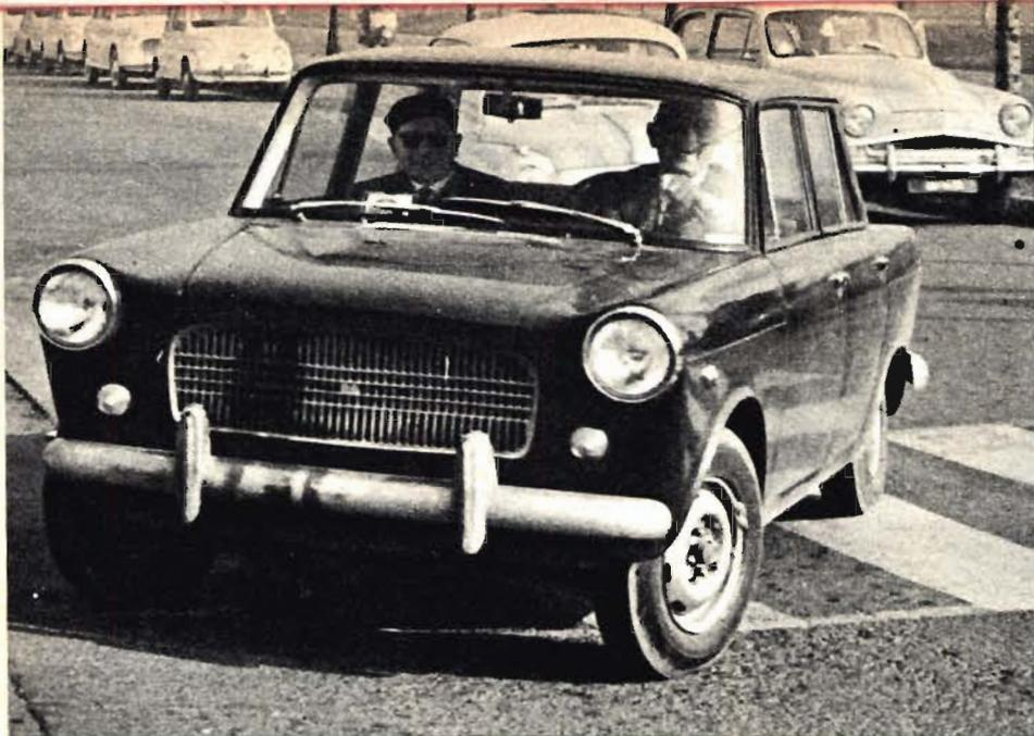
**IL PROTOTIPO** della Fiat 1300, in collaudo. La nuova vettura sta rispondendo ottimamente alle prove. Il motore, a quattro cilindri, raggiungerebbe una velocità effettiva di 130 chilometri orari. Pare che le ruote anteriori verranno dotate di freni a disco.
