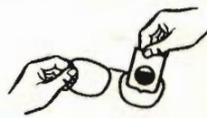
Ruotando il filtro di controllo la luce non passa più. Ciò garantisce che le lenti sono otticamente polarizzate.
