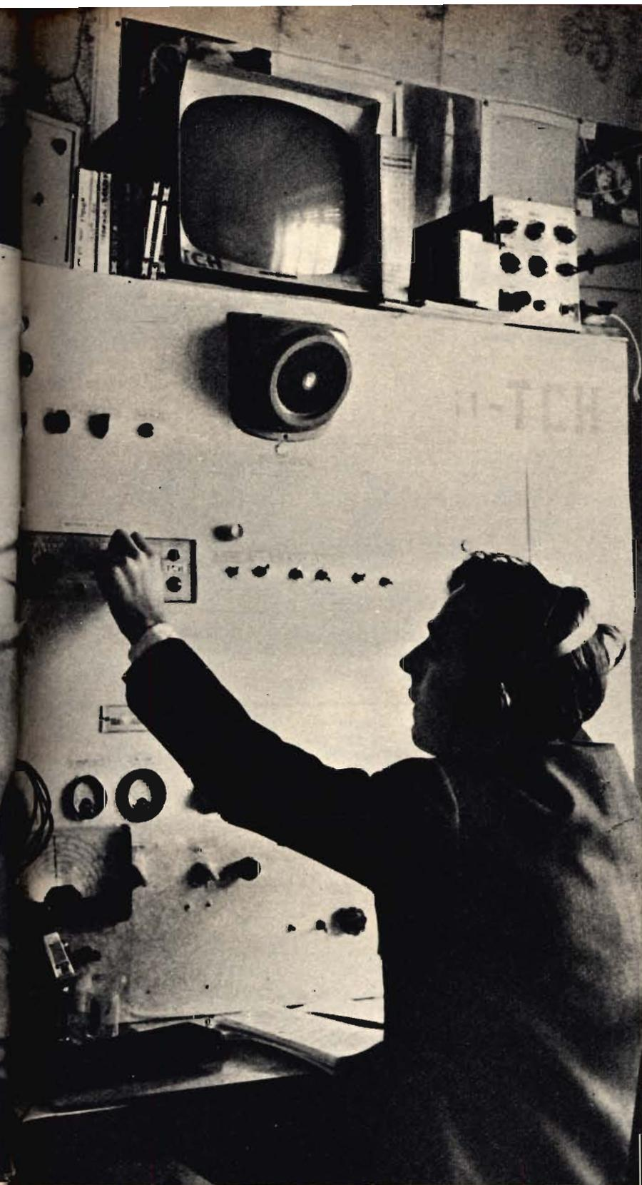
Composto da dieci tubi elettronici, l'apparato è fornito di perfezionatissimi strumenti di controllo, che permettono di determinare e classificare le varie emissioni. Questa stazione fu la prima in Europa a captare, il 5 ottobre 1957, il segnale lanciato dallo «Sputnik 1». È collegata costantemente ad un magnetofono, che ha registrato tutte le trasmissioni dei satelliti americani e russi.
