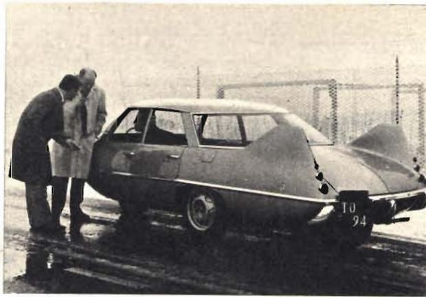
La berlina «Sperimentale X» della Carrozzeria Pininfarina in prova su strada. Si noti la disposizione delle ruote.
