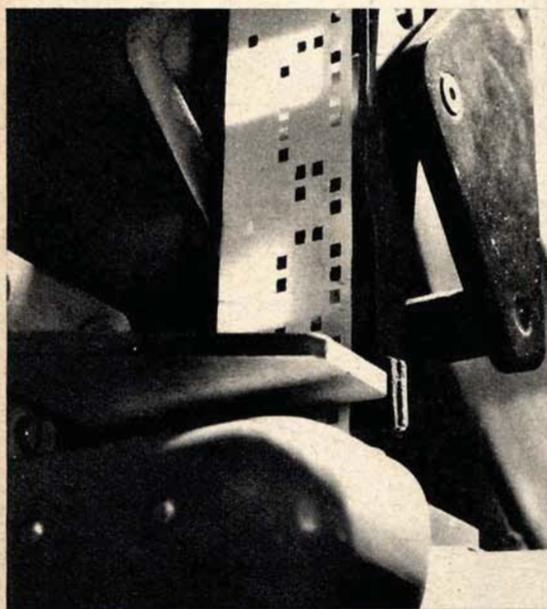
**3** È necessario ora che i dati corrano nei circuiti del calcolatore ad una velocità fantastica. Dalle perforazioni è necessario cioè ricavare dei segnali elettronici. Tale risultato si ottiene mediante l'impiego della cellula fotoelettrica.
