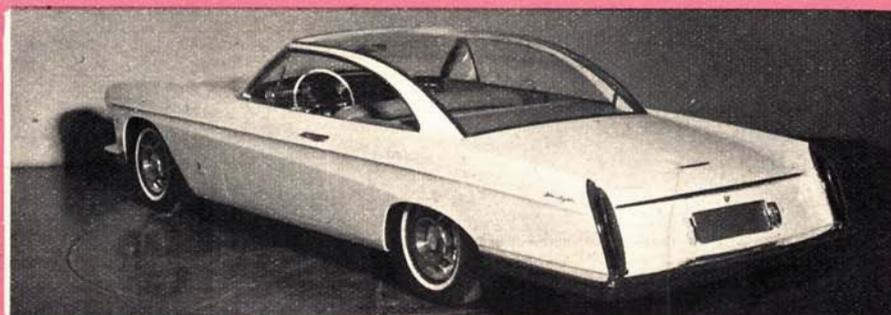
Pinin Farina per telaio Cadillac 1960 ha realizzato questo *coupé* « Starlight », di linea assai snella nonostante le notevoli dimensioni. Caratteristico il padiglione ultra aerodinamico e quasi per intero trasparente. Altre particolarità: sedile unico a più posizioni manovrabile a mezzo di comando elettrico, alzacristalli servocomandati. Pinin Farina presenterà numerose altre novità.
