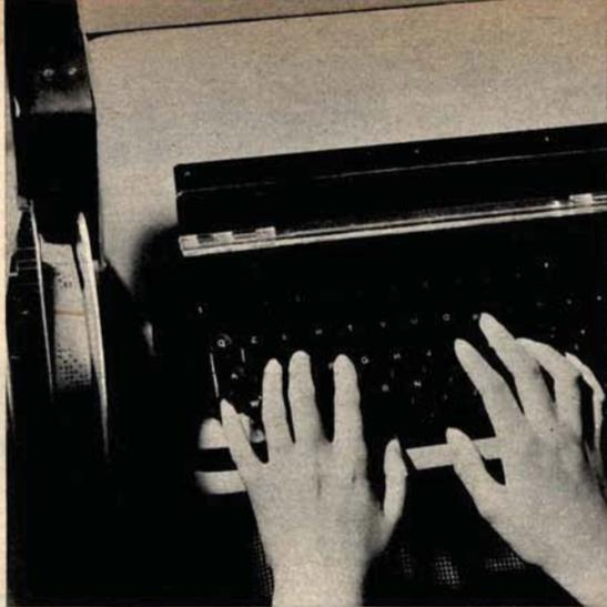
**1** Inizia il lavoro del calcolatore Eia: su una macchina simile ad una comune macchina per scrivere, si battono i dati da introdurre nel calcolatore. I dati, con una speciale codificazione, si incidono su un nastro di carta perforata.
