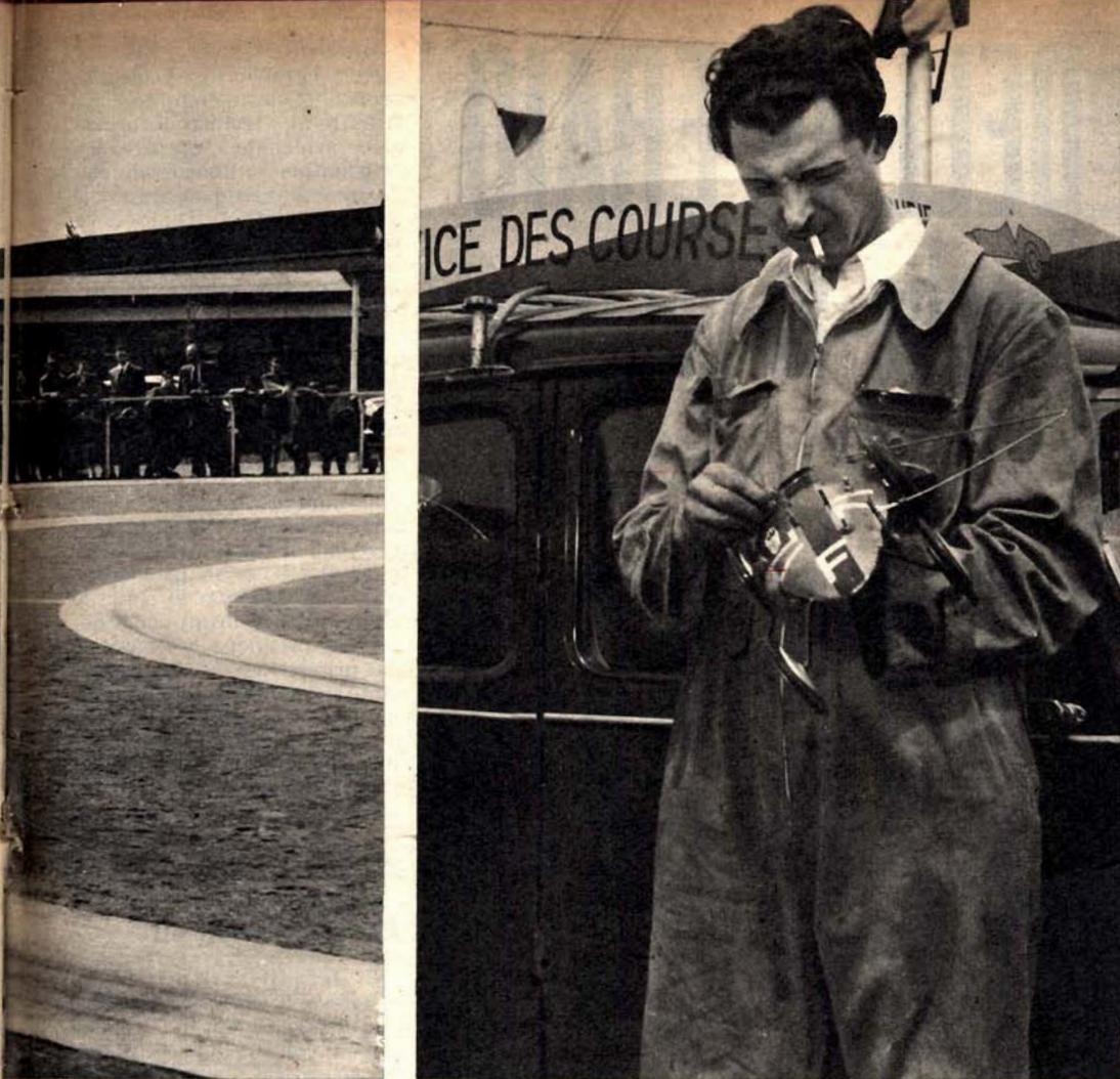
Un componente della scuderia Plus-Plus di Parigi alle recenti gare di Torino. Le automobiline vengono lanciate per mezzo d'un bastone cui è applicata una batteria che avvia il motore.
