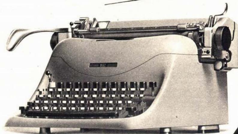
La prima macchina per scrivere da ufficio con carrello monoguida e con carrozzeria amovibile su telaio a struttura reticolare. Il cinemático ad accelerazione progressiva assicura un tocco leggerissimo e consente di ottenere la massima velocità di scrittura con la minima fatica. Può essere fornita con interpolatore o con tabulatore decimale.
