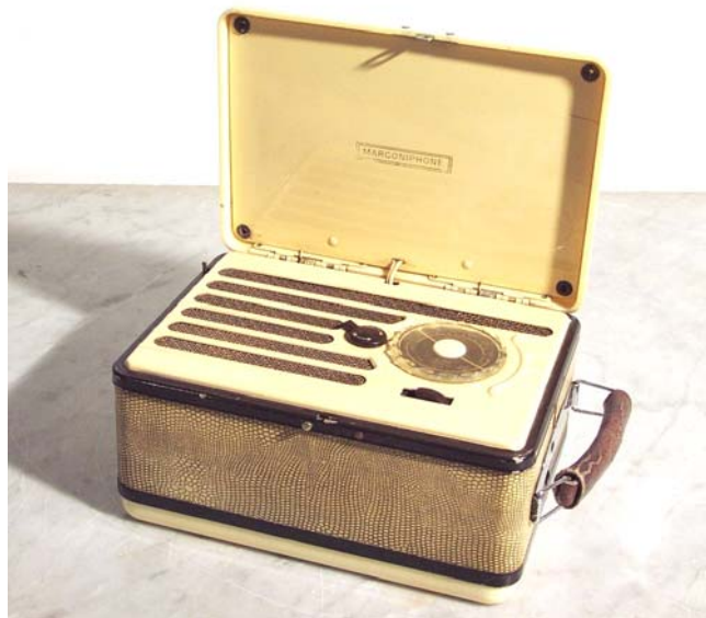
Fig. 6 – Apparecchio portatile a valvole miniatura, con alimentazione a pile (1953)
