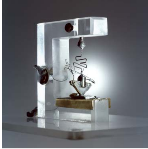
Fig. 8 – Questo è l’aspetto del primo transistor, usato dagli inventori per una storica dimostrazione presso i Bell Labs il 23 dicembre 1947
