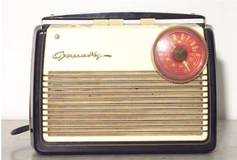
Fig. 7 – Grundig “Transistor Boy” (1958), raro esempio di radio a tecnologia ibrida con valvole e transistor. I transistor erano usati nello stadio finale
