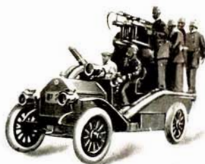
Carro Bianchi speciale auto-pompa "motore 40-40 HP - pompa della portata di 1200 litri al minuto - adottato da diversi corpi di Pompiere.
